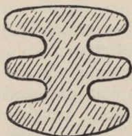
Fig. 6. Neuer englischer Patentriemen (Querschnitt).
