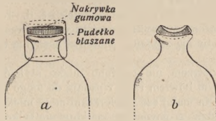
Fig. 22. Soxhlet'a zamknięcie tarczą gumową: a przed gotowaniem, b po gotowaniu i ochłodzeniu.
