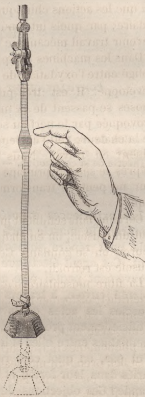
Fig. 9. — Transformation de la chaleur en travail par un fil de caoutchouc.
