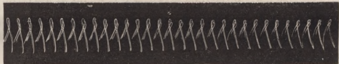
Fig. 79. — Graphique d'une verge de Wheatstone accordée à l'octave, munie d'une aile de guêpe et orientée de manière à enregistrer surtout la boucle supérieure du 8.
