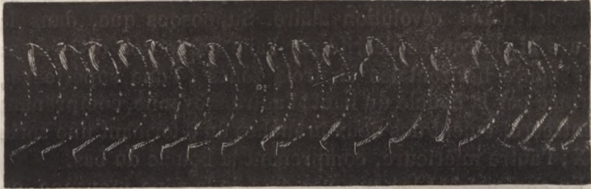
Fig. 74. — Cette figure montre, dans le graphique d'une guêpe, la boucle supérieure et toute l'étendue d'une des branches du 8. La partie moyenne de cette branche est seulement ponctuée à cause du faible frottement de l'aile.
