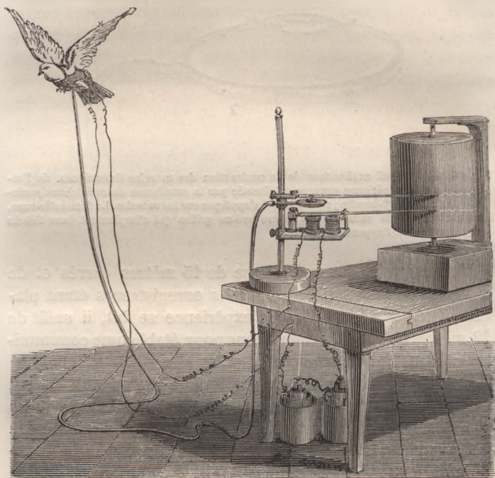
Fig. 94. — Expérience pour déterminer par la méthode électrique et par la méthode myographique, à la fois, la fréquence des mouvements de l'aile et les durées relatives de ses temps d'élévation et d'abaissement.
