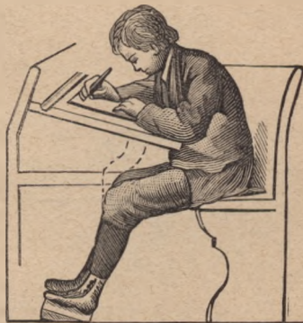
Fig. 12. Wadliwe siedzenie wskutek zbyt oddalonego oparcia ławki i zbyt wielkiej odległości pomiędzy ławką a stołem.
