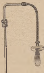
Fig. 4. Aparat ssący do flaszek Soxhlet'a.
