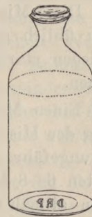
Fig. 50. Flasche nach Soxhlet mit Gummiplattenverschluss.
