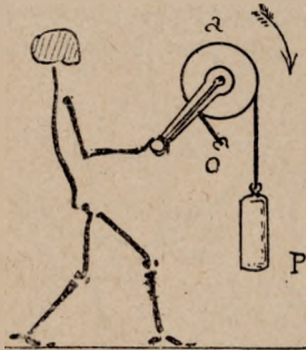
Fig. 275. — Machine gymnastique destinée à faire produire du travail au moyen des bras.
