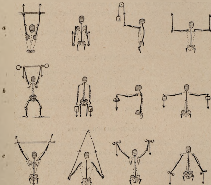
Fig. 226. — a . Résistance dirigée vers le haut et réactions musculaires qu'elle suscite ; — b . résistance dirigée vers le bas avec les réactions musculaires ; — c . résistance oblique en haut et oblique en bas.
