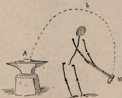
Fig. 169. — Trajectoire de la masse du marteau allant frapper l'enclume en A. La main se déplace le long du manche pour économiser l'effort.
