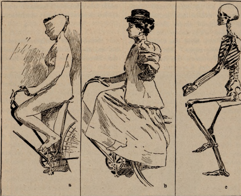
Fig. 3. b, c. Falscher Sitz mit zu stark gekrümmtem Knie, herrührend entweder von falscher Bewegung des Fussgelenks oder von zu niedrig stehendem Sattel. Der linke Absatz steht zu hoch, der rechte zu tief. Der falsche Sitz zieht auch Schwierigkeiten beim Tragen des Kleides nach sich, wie aus den Falten am Rock zu ersehen ist. Fig. a sitzt auf einem genügend nach vorn gestellten Sattel, so dass die Knie nicht zu hoch stehen, während die Oberschenkel von Fig. b und c fast horizontal sind.
