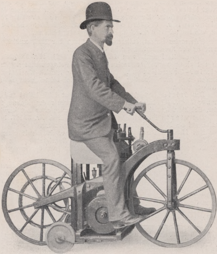
Das erste Daimlermotorzweirad mit Ingenieur Maybach 1886.
