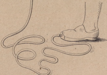
Fig. 414. Druckmessendes Schuhwerk nach Marens mit Registrierapparat. L Luftkammer; H Schreibhebel; Sr rotierende Trommel.
