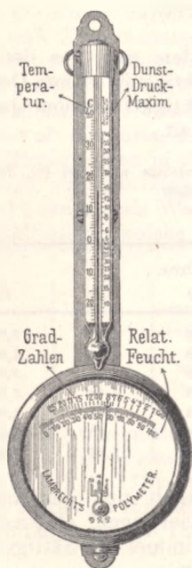
Fig. 199. Lambrecht's Polymeter. Nach einem Preis-kurant von Lambrecht.
