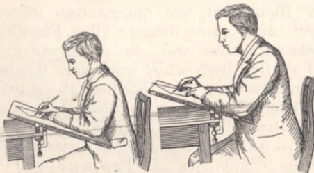
Fig. 162. Für verschiedene Körpergrößen einstellbare Pultplatte nach Schulthess.
