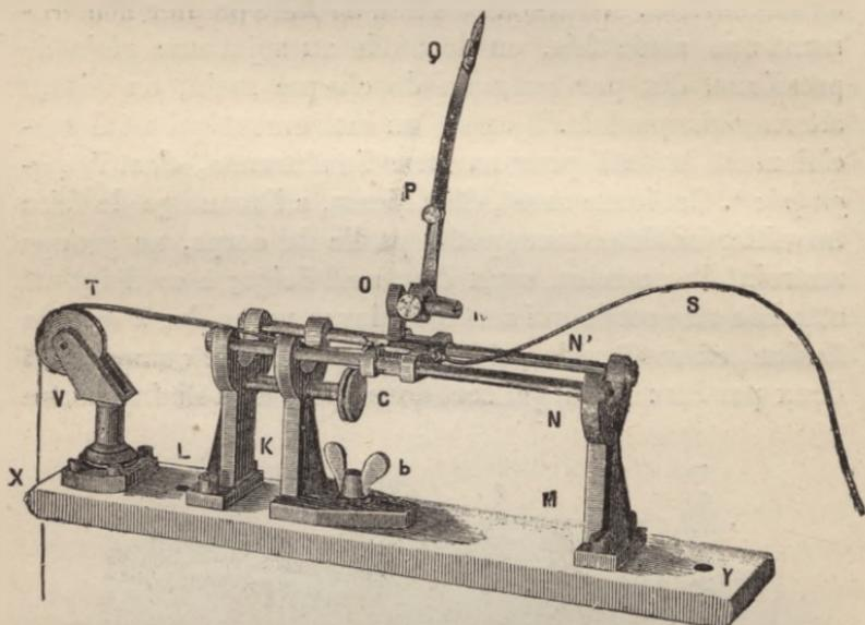
Fig. 66. — Curseur enregistreur de l'ergographe de Mosso. La corde S est attachée à la 3<sup>e</sup> phalange du médius; à la corde T est suspendu le poids. La plume PQ écrit sur un cylindre tournant.
