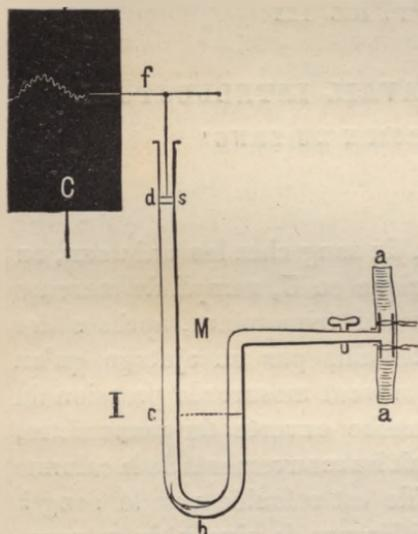
Fig. 37. — Inscription de la pression sanguine chez un animal. *a a* est une artère dans laquelle est introduite une canule ; cette canule communique avec un manomètre *M*, le sang refoule le mercure du manomètre jusqu'en *c*, le mercure monte jusqu'en *s*. La pression du sang est donc égale au poids d'une colonne de mercure égale à *s c*. (Landois.)
