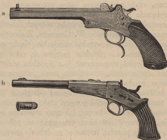
Fig. 47. a) Pistolet tarczowy odcylkowy, b) pistolet tarczowy odcylkowy Remington'a.
