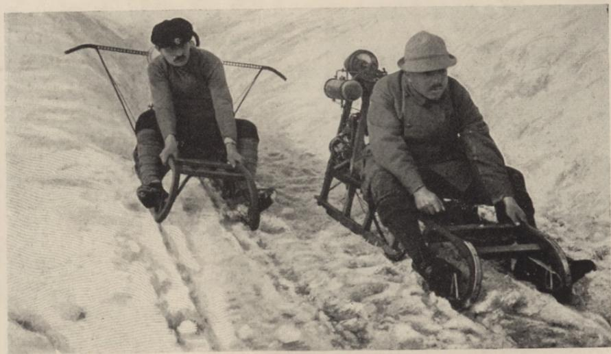
LE TRAINÉAU AUTOMOBILE. — Deux modèles assez curieux de traîneaux légers actionnés par un moteur placé à l'arrière.
