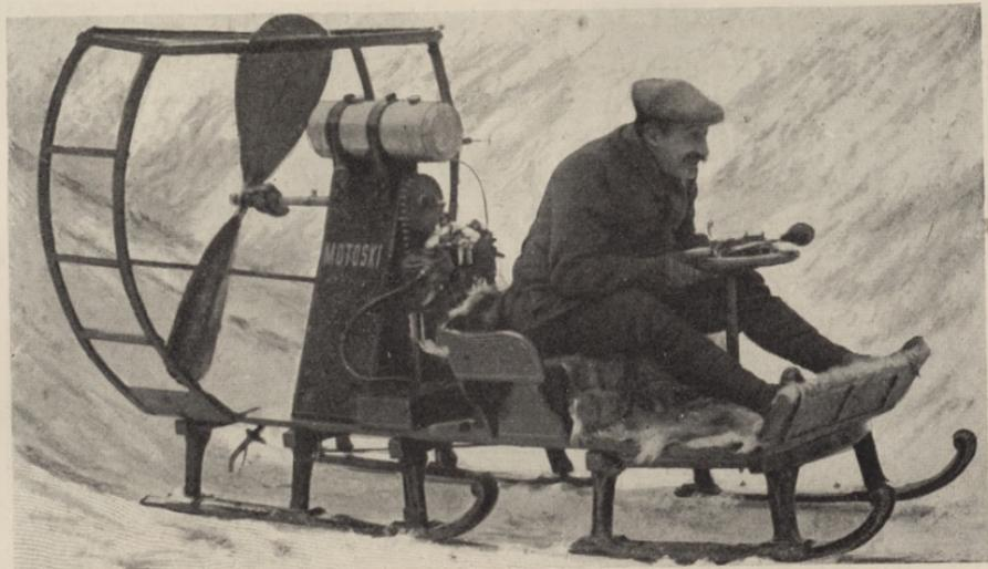
LE TRAINÉAU AUTOMOBILE. — Ce modèle est une variante du traîneau de M. Nivert. Plus court, plus léger, il est muni d'une hélice aérienne.
